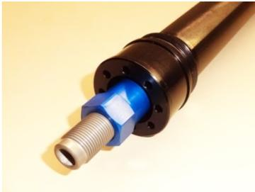
Prendere la nuova cartuccia MINIPRO, applicare grasso sull'o-ring inferiore per consentire un migliore scorrimento all'interno dello stelo, applicare la Loctite sul filetto superiore da 31mm e stringerlo sullo stelo utilizzando l'apposita chiave in foto.
