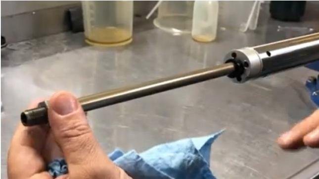
Smontare il fodero dal lato idraulico e smontare la cartuccia interna di serie dallo stelo 35 mm con l'apposita chiave.
