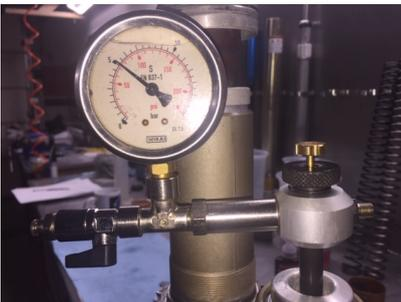
INSERIRE 5 BAR ALL'INTERNO DEL PRESSURIZZATORE.
