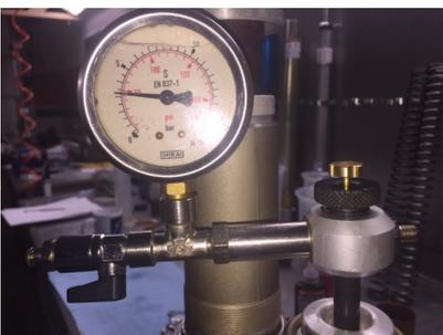
AVVITARE IL POMELLO ORO FINO A CHE NON SI VA A SPINGERE LA VALVOLA INTERNA E SI VEDE CALARE LA PRESSIONE NEL MANOMETRO.
